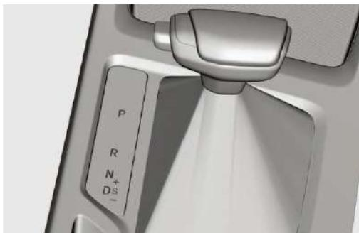
Estacionar el vehículo en el cambio P, el motor se puede arrancar en esta posición.
