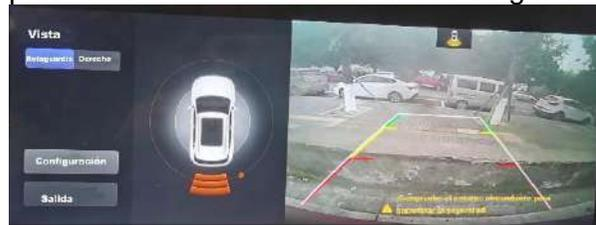
La línea guía de estacionamiento constan de dos partes: una línea estática y una línea dinámica. La dirección longitudinal se extiende unos 3 m hacia atrás desde el parachoques, y la dirección lateral es el ancho del vehículo (incluido el espejo retrovisor exterior).
