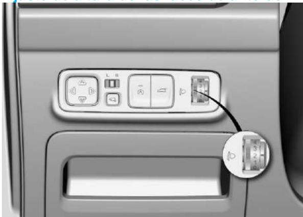
Cuando la altura del vehículo cambia con la carga, aceleración, desaceleración y otras condiciones, es posible ajustar la inclinación de las luces delanteras bajo con el interruptor. Tire del interruptor hacia arriba y el ángulo de las luces aumentará (-> 0, distancia de iluminación más larga); presione el interruptor hacia abajo, y el ángulo de las luces desciende (-> 5, distancia
