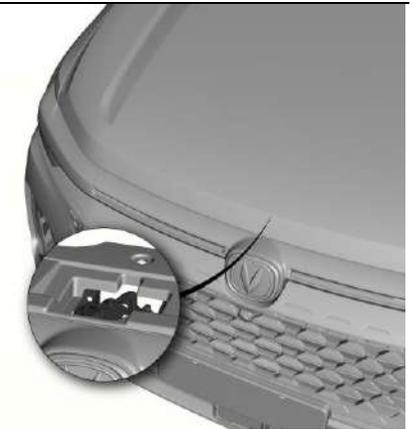
3. Levante el capó del motor y apóyelo con la varilla de soporte.
