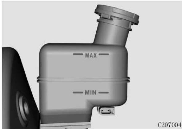
El nivel del líquido de frenos es bajo. Agregue líquido de frenos a MAX.
