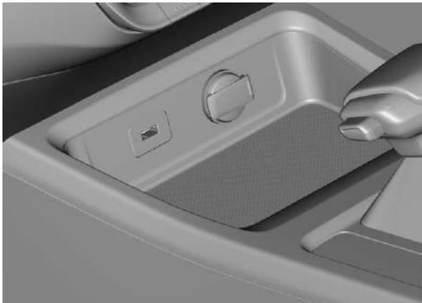
La interfaz USB interno se puede utilizar para cargar y los elementos adecuados se pueden colocar al mismo tiempo.
