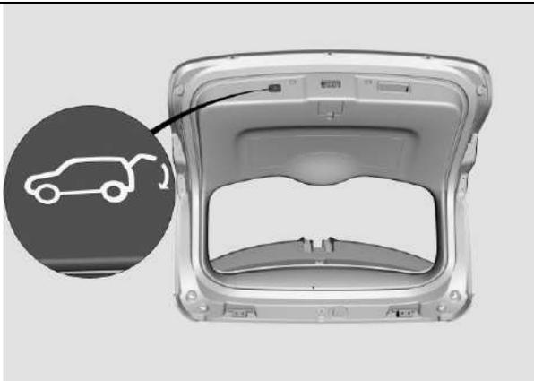
Durante el proceso de cierre de la puerta trasera eléctrica, presione el interruptor de la manilla o el interruptor interior de la puerta trasera nuevamente, y la puerta trasera eléctrica se elevará;
