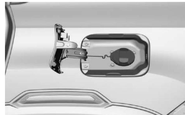
5. Coloque la tapa de recarga en la parte trasera de la puerta del tanque.
