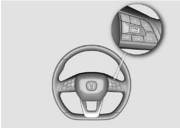
El instrumento combinado tiene dos teclas en el volante.
