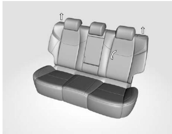
Tire hacia arriba la manilla de desbloqueo del respaldo, gire el respaldo hacia adelante hasta el estado plano y bloquee el ajuste de ángulo después de desbloquear el ajuste de ángulo, para realizar la función de expansión del espacio de almacenamiento del portamaletas.
