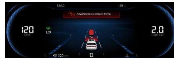
Si el peligro de colisión con el vehículo delantero aumenta aún más, el sistema de freno de emergencia autónomo activará un frenado breve y rápido.
