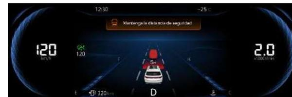
Cuando el vehículo circula a velocidades medias y altas, si existe peligro de colisión con el objetivo adelante, el instrumento indicará "Peligro de colisión" y una alarma sonora continua. Esta alarma funciona cuando la velocidad del vehículo está en el siguiente rango:
