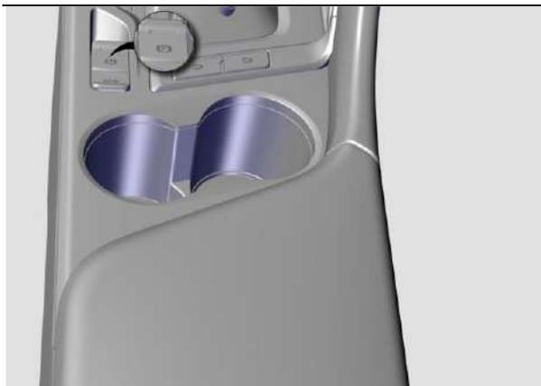
Al soltar el freno de estacionamiento, primero presione el pedal del freno, luego presione el interruptor EPB, el estacionamiento se libera y el indicador correspondiente se apaga.
