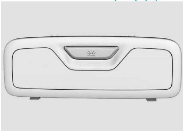
Sunroof pequeño, una sola luz de lectura trasera en el medio de la fila trasera del techo; presione el interruptor de la luz de lectura para encender la luz, y presione nuevamente para apagar la luz.
