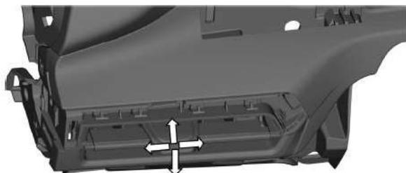
① Ajuste la compuerta hacia arriba / abajo, hacia la izquierda / derecha para cambiar la dirección del aire.
