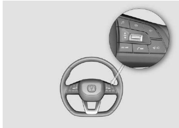
El instrumento combinado es una tecla de cuatro direcciones en el volante.
