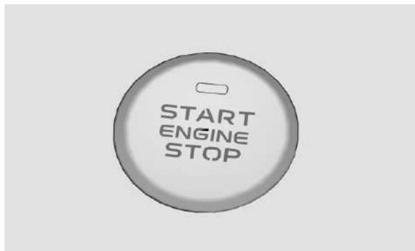
Cuando la llave inteligente se encuentra dentro del área de activación de la función start/stop, presione el botón "START ENGINE STOP" para encender o apagar el motor, o cambiar las posiciones de suministro de alimentación (ACC, ON y OFF).
