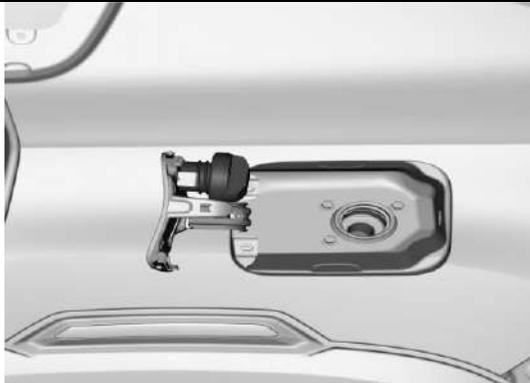
6. Colocar la boquilla de la pistola de combustible completamente en el tanque de combustible, luego fijela y comience a llenar.
