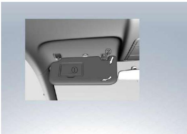
①-Espejo de maquillaje ②-Base de fijación
