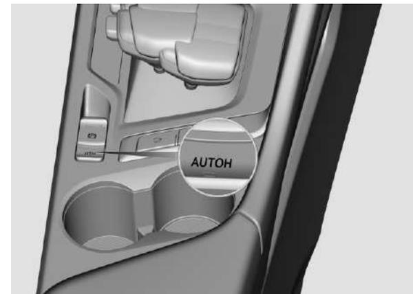
La función AUTO HOLD mantiene la presión de los frenos a través del ESC y ayuda al conductor a estacionarse automáticamente. Incluso si el conductor suelta el pedal del freno, el vehículo no se moverá. Presione el pedal del acelerador para cumplir con las condiciones de arranque, el estacionamiento se libera automáticamente y el vehículo arranca suavemente.
