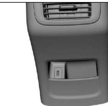
La interfaz USB interna se puede utilizar para cargar y los elementos adecuados se pueden colocar al mismo tiempo.
