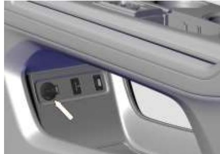
La toma de corriente proporciona una potencia de 12VCC y la potencia de salida eléctrica es  $\leq 120$  W.
