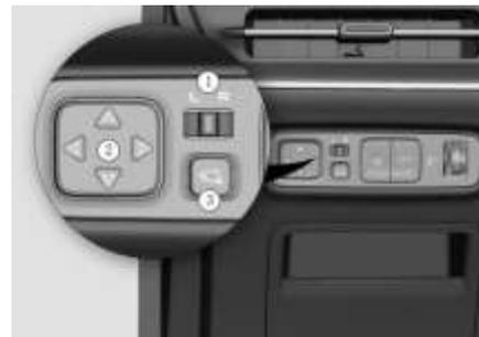
1. Seleccionar espejo retrovisor: Gire la perilla del interruptor principal para cambiar el espejo retrovisor exterior izquierdo (L) / derecho (R).
