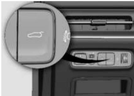
Durante el proceso de apertura de la puerta trasera eléctrica, presione nuevamente el interruptor de la puerta trasera del lado del conductor y la puerta trasera eléctrica se elevará; después de elevarse, presione el interruptor de la puerta trasera del conductor nuevamente y la puerta trasera eléctrica continuará abriéndose.
