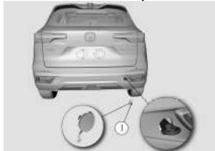
abra la cubierta de instalación del gancho de remolque del parachoques trasero ①, abra la cubierta y apriete el gancho de remolque trasero para usar.
