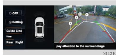
La línea guía de estacionamiento consta de dos partes: Una línea estática y una línea dinámica. La dirección longitudinal se extiende aproximadamente 3mts hacia atrás desde el parachoques, y la dirección lateral es del ancho del vehículo (incluidos los retrovisores).
