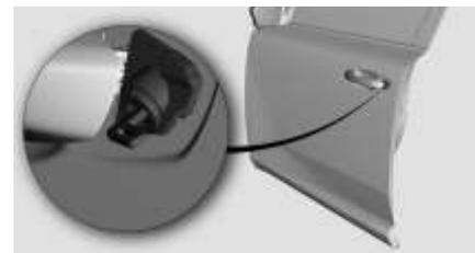
**Desbloquear:** Deslice la tapa trasera de la llave → saque la llave mecánica → tire hacia arriba de la manilla exterior e inserte la llave mecánica de manera oblicua → gire la llave mecánica en sentido antihorario → saque la llave mecánica y suelte la manija → exterior abra la puerta normalmente.
