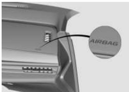
No utilice la cubierta de la bolsa de aire del pasajero delantero como estante de almacenamiento. Mantenga el panel de instrumentos y el parabrisas en el lado del pasajero delantero libre de cualquier objeto y obstrucciones. No use cinta adhesiva o algún recubrimiento, ni instale algún soporte (como el de un equipo de navegación o un teléfono celular) en ellos.
