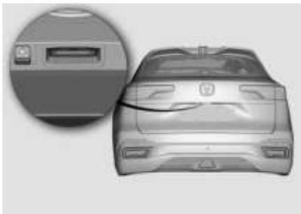
La puerta trasera se puede desbloquear accionando el botón de apertura de la puerta trasera en el parachoques trasero dentro de los 30 segundos posteriores a la apertura del vehículo. En este momento, levante la puerta trasera. Cuando la puerta trasera alcance la posición de equilibrio, se abrirá automáticamente y la luz del portamaletas estará encendida.
