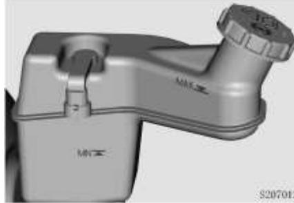
Si el nivel de líquido está bajo, agregue líquido de frenos hasta que el nivel llegue a MAX.
