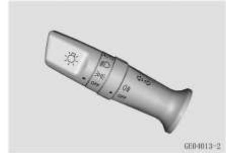
**AUTO** ※ (si equipa): Con la manilla en la posición AUTO, el foco se enciende y apaga automáticamente según la luz del medio ambiente.
