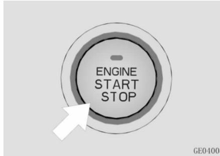
Cuando la llave inteligente se encuentra en el área de activación de arranque con un botón, presione el interruptor "ENGINE START STOP" para arrancar o detener el
