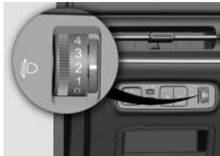
Quando la postura del vehículo cambia con el estado de carga del vehículo, la aceleración o desaceleración, etc., la inclinación de los faros se puede ajustar a través de este interruptor.
