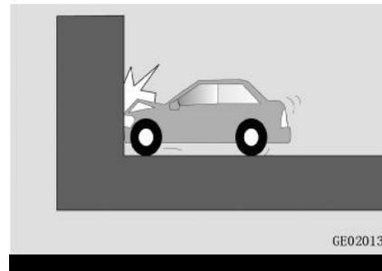
2. El vehículo choca con una columna de hormigón inamovible e indeformable a una velocidad puntual de no más de 35 km/h.
