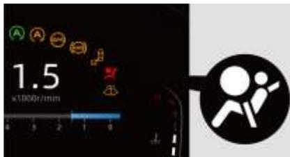
Cuando el interruptor de encendido está en la posición "ON", la luz indicadora del SRS permanecerá encendida durante un tiempo de 3 a 6 segundos y luego se apagará. En estado normal de funcionamiento, la luz indicadora permanecerá apagada después de su auto comprobación.
