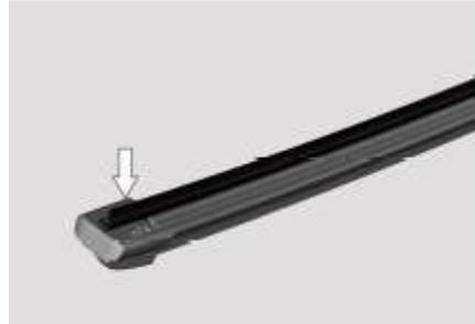
Si el parabrisas o la plumilla del limpiaparabrisas se contaminan con materias extrañas, la función del limpiaparabrisas disminuirá. La fuente común de contaminación incluye insectos, savia y cera térmica utilizada para el lavado de vehículos comerciales. Si las plumillas del limpiaparabrisas no están limpias, utilice líquido limpiador de alta calidad o un agente de lavado suave para limpiar el parabrisas y plumillas
