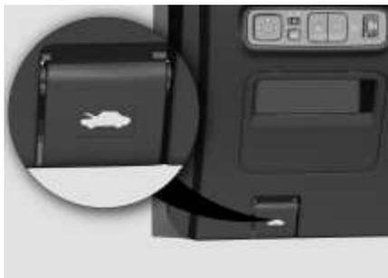
2. Mueva El seguro de desbloqueo en el centro delantero del cofre del motor hacia la derecha hasta que se pueda levantar el cofre.
