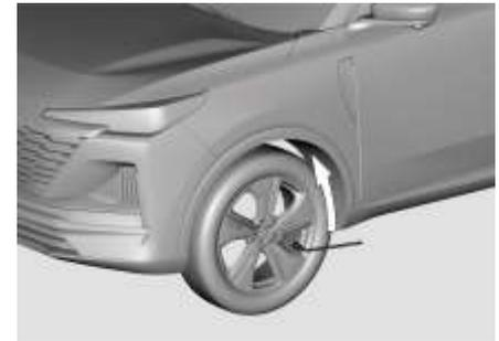
2. La posición de soporte del gato está en el espacio que se muestra en la figura, y la ranura de el gato coincide con la ubicación de la parte
