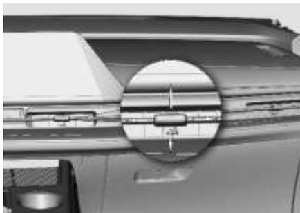
① : Ajuste el regulador hacia arriba o hacia abajo, hacia la izquierda o hacia la derecha para cambiar la dirección del aire.
