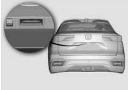
Con las cuatro puertas laterales cerradas, si deja la llave inteligente en el portón trasero, cierre la puerta trasero y las cuatro puertas laterales se desbloquearán automáticamente.
