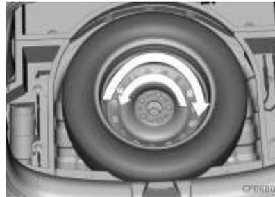
Gire el perno de la placa de presión en sentido antihorario para sacar la llanta de refacción.
