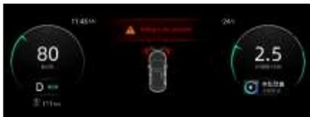
Si el peligro de colisión con el vehículo delantero aumenta aún más, el sistema de freno auxiliar de alerta temprana activará un freno breve y rápido.
