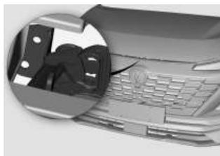
3. Inserte la varilla de soporte en la ranura de la placa de montaje del parachoques para sostener la cubierta del motor, a fin de mantener la cubierta del motor en su posición de apertura.
