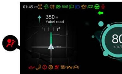
El testigo del SRS está en rojo. Cuando la fuente de alimentación ESTÁ ENCENDIDA, el indicador luminoso del SRS permanece encendido durante aproximadamente 3~6s y, a continuación, se apaga. En el estado de funcionamiento normal, el indicador luminoso se apaga.
