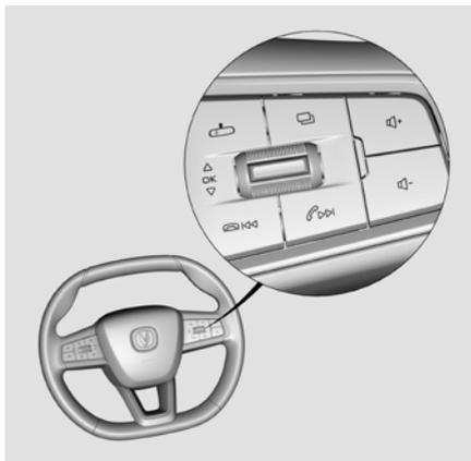
El panel de instrumentos es una llave de cuatro direcciones en el volante.
