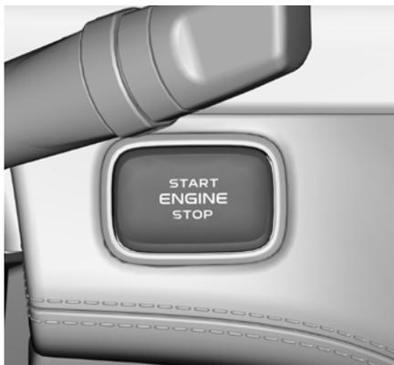
Cuando la llave inteligente se encuentra en el área de activación de una llave de contacto, pulse el interruptor "START ENGINE STOP" para arrancar o parar el motor o cambiar las posiciones de alimentación (ACC, ON y OFF).
