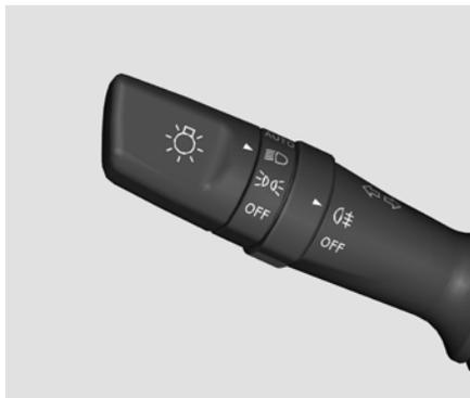
Gire la palanca de control de la luz **D**, gire el interruptor de la luz antiniebla en el sentido de las agujas del reloj a, **D** la luz antiniebla trasera se encenderá, el interruptor de la luz antiniebla se encenderá y verá las luces apagadas
