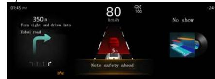
Cuando el vehículo está conduciendo a velocidades medias y altas, si existe peligro de colisión con el objetivo en el frente, el instrumento indicará "Peligro de colisión" y una alarma de sonido continuo. Tanto las limitaciones de detección de la cámara como del radar afectarán
