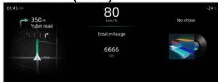
Registre el total de kilómetros. Rango de visualización: 0-999999km, cuando el kilometraje total exceda de 999999km, se mantiene en 999999km sin cambios.
