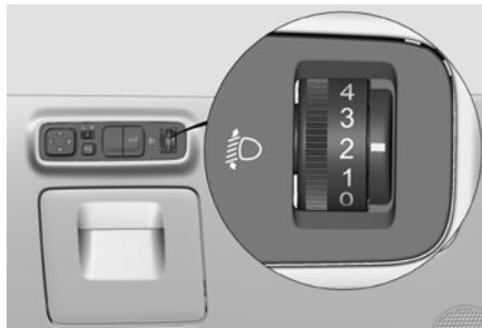
Quando la postura del vehículo cambia con el estado de carga del vehículo, la aceleración o desaceleración, etc., la inclinación de la luz de cruce se puede ajustar mediante este interruptor.
