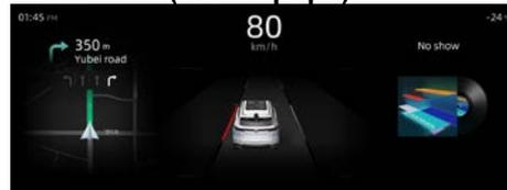
Muestra la información de detección de la línea de carril y la alarma del sistema de asistencia de carril. Para obtener una descripción detallada de las funciones, consulte
