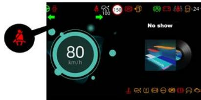
La luz indicadora del cinturón de seguridad se encenderá si el conductor o el acompañante delantero no usan cinturones de seguridad. Cuando el vehículo está en marcha, el testigo del cinturón de seguridad se mantiene
