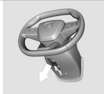
2. Ajuste el volante hacia arriba/abajo/hacia delante/hacia atrás en la posición adecuada;
