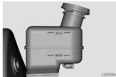
Si el nivel de líquido es bajo, agregue líquido de frenos hasta que el nivel llegue a MAX. Si se enciende la luz indicadora de fallas en el sistema de frenos en el panel de instrumentos, verifique el nivel del líquido de frenos para ver si es demasiado bajo. Si el líquido es bajo, el rendimiento del sistema puede verse afectado. Si el nivel de líquido es sospechosamente bajo (o baja rápidamente), acuda a una embajada CHANGAN para realizar el mantenimiento / reparación lo antes posible.
