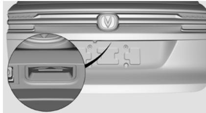
Para desbloquear el vehículo o si la llave se encuentra en la zona de activación de la puerta trasera (en un intervalo de 0,8m), mantenga pulsado el botón de apertura de la puerta trasera y levante la puerta trasera. Al alcanzar la posición de equilibrio, la puerta trasera se abrirá automáticamente y la luz del maletero se encenderá.
