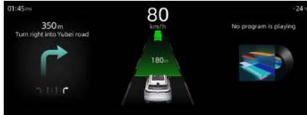
Muestra la siguiente información, distancia de tiempo, velocidad de cruceo, y muestra los recordatorios y alarmas relacionados con el sistema de resistencia. (modelos con funciones relevantes)
