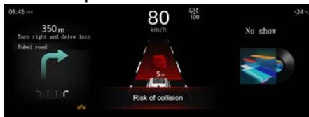
Si el riesgo de colisión con el vehículo delantero aumenta aún más, la función de frenado de emergencia automático activará un breve frenado rápido
