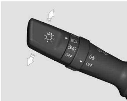
Gire la palanca de control de la luz a **D** y la luz de cruce se encenderá. Empuje ahora la palanca de control de luces hacia delante para encender la luz de carretera (alta).
