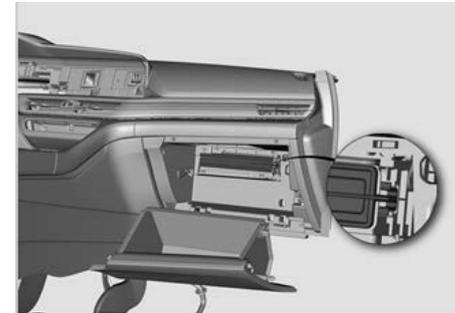
3. Sustituir el filtro de aire del aire acondicionado
