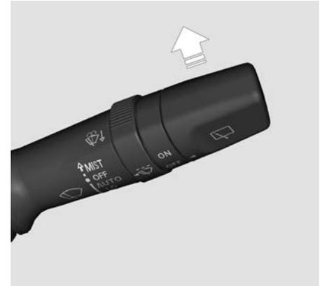
Empuje la palanca de control del limpiaparabrisas para alejarla de la dirección del conductor y el limpiaparabrisas trasero funcionará. Una vez que la palanca de control del limpiaparabrisas vuelve a su posición original, el lavaparabrisas trasero deja de funcionar y el limpiaparabrisas continúa funcionando durante un breve periodo de tiempo.
