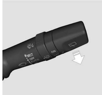
Tire suavemente de la palanca del limpiaparabrisas hacia atrás y el lavaparabrisas comenzará a funcionar. Cuando el lavaparabrisas se detiene, se detiene después de funcionar durante un breve período de tiempo.
