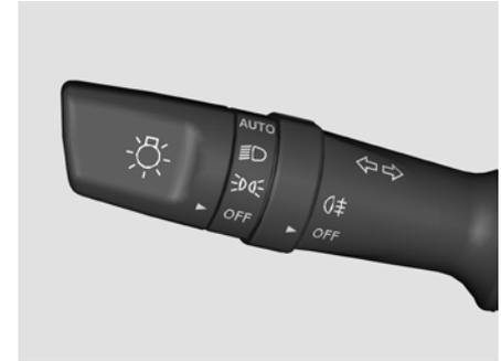
**AUTO**※ (si lo equipa): Con el mango en la posición AUTO, el faro se encenderá y apagará automáticamente en función del brillo ambiental
