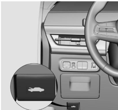
2. Mueva la lengüeta de desbloqueo situada en la parte delantera central del cofre del motor se eleva hacia la derecha hasta que se puede levantar el cofre del motor
