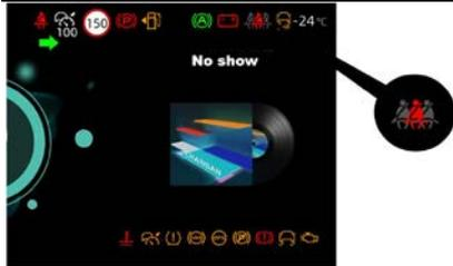
Cuando el vehículo arranca, si el cinturón de seguridad trasero no está abrochado, se encenderá el indicador del cinturón de seguridad correspondiente.
