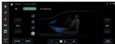
La función de calefacción del asiento del conductor y del pasajero delantero se puede encender/apagar a través de la pantalla multimedia [Centro del vehículo]-[Aire acondicionado]-[Confort de asiento].
