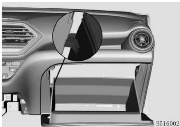
2. Presione el botón del lado derecho para abrir la cubierta del filtro de aire del aire acondicionado y extraiga el núcleo del filtro de aire del aire acondicionado.
