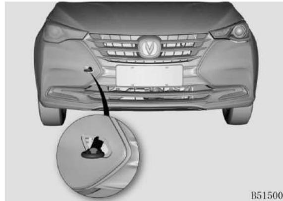
Retire la cubierta de montaje del gancho de remolque del parachoques delantero y apriete el gancho de remolque para usar.
