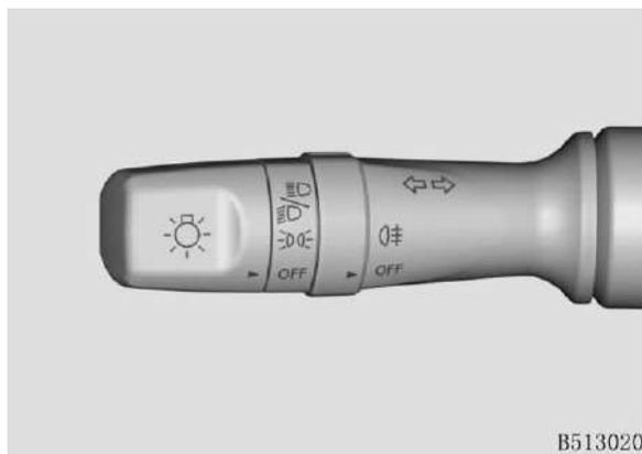
Apagado (OFF): con la palanca en la posición OFF, cuando la fuente de alimentación del vehículo está en la posición OFF/ACC, todas las luces se apagan; cuando la fuente de alimentación del vehículo está en la posición de ON/START, todas las luces se apagan, excepto la luz de circulación diurna.
