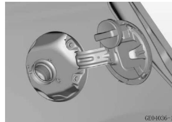
6. Coloque la boquilla de la pistola de combustible completamente en el depósito de combustible, luego fíjela y comience a llenar.
