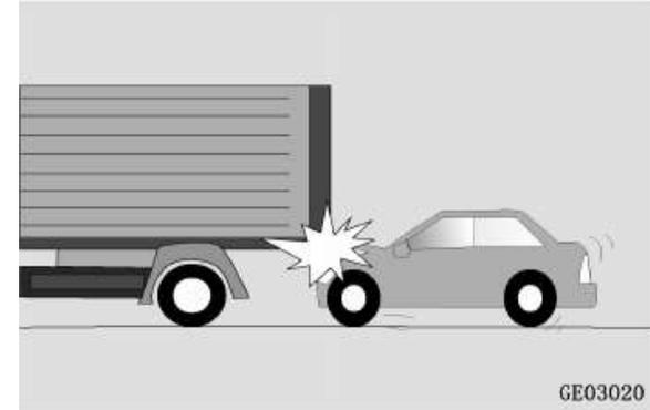
(1) El dispositivo de protección del camión es de baja resistencia y capaz de deformación flexible.
