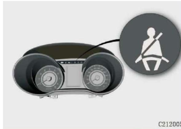
Cuando el vehículo está en marcha, la luz indicadora del cinturón de seguridad permanece encendida y emite un tono de advertencia si el conductor o el pasajero delantero no usan los cinturones de seguridad. Ya sea que el conductor o el pasajero delantero todavía no se abrochan el cinturón de seguridad, el tono de advertencia se apagará unos 5 minutos más tarde.
