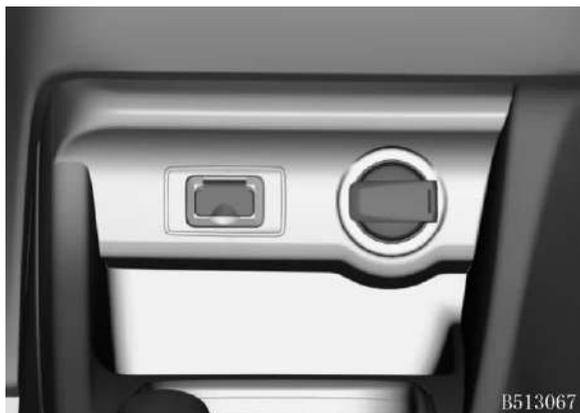
Hay el zócalo delantero y el zócalo del tronco. Se suministra la alimentación de 12 V CC y la potencia de los aparatos eléctricos no debe ser superior a 120 W.
